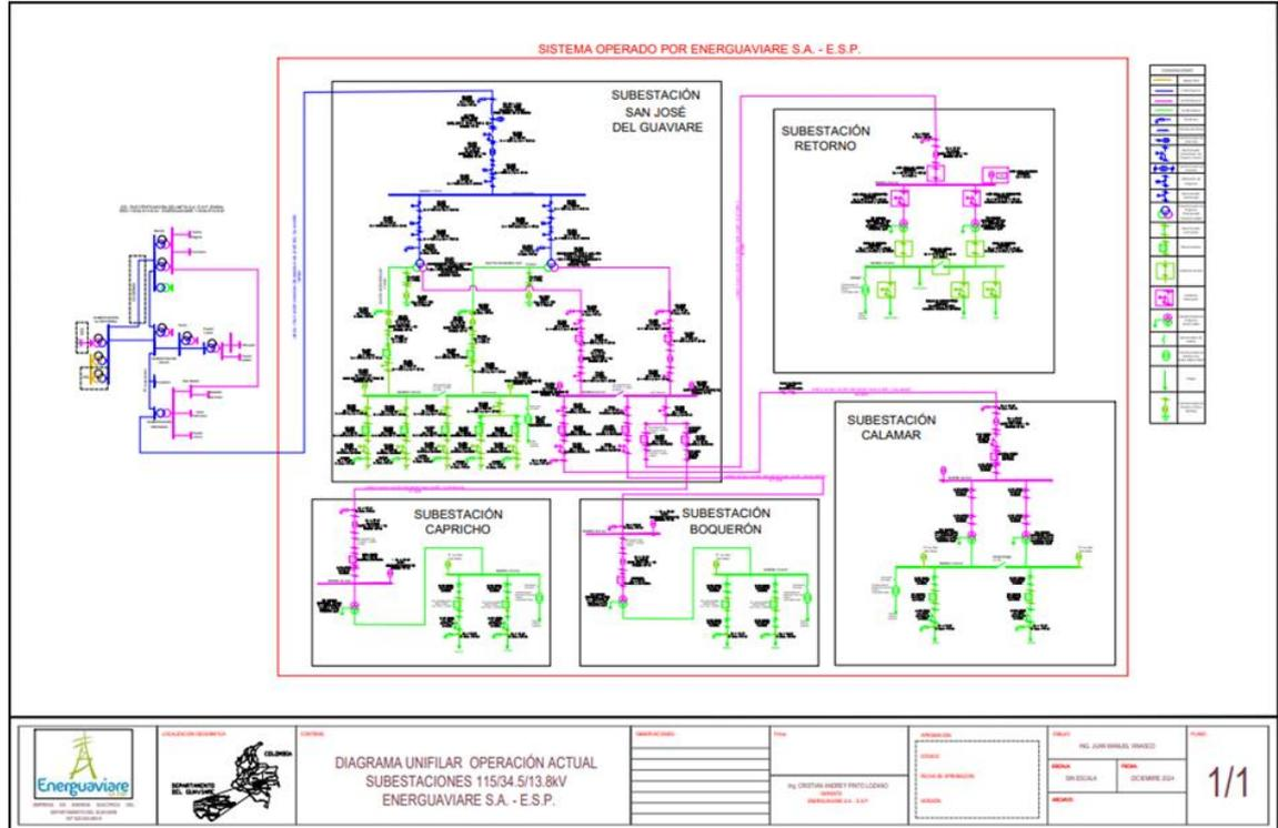
Imagen 4- Diagrama Unifilar de Subestaciones de ENERGUAVIARE S.A E.S.P.
